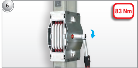
Hizalamaların kontrolü sağlandıktan sonra blok ek somunları 83 Nm ile torlanılır.
