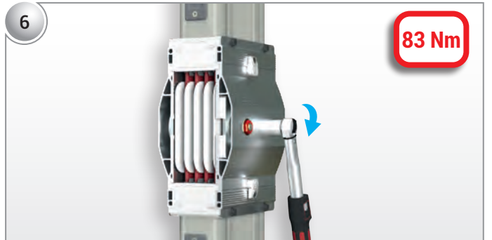
Hizalamaların kontrolü sağlandıktan sonra blok ek somunları 83 Nm ile torklanır.
